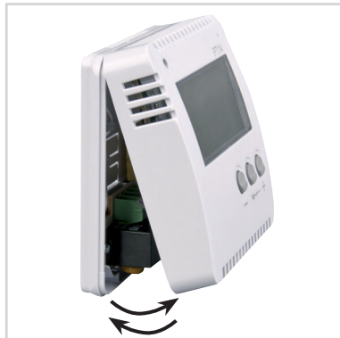
Rys.4 Połączyć obudowę i zabezpieczyć śrubą łącznikową.
